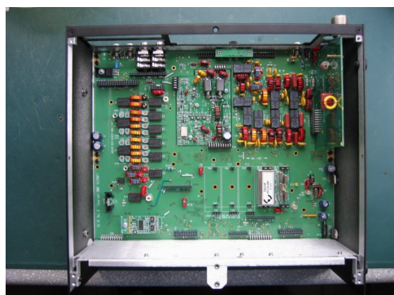
Bild: Einbau 10 Watt Pa
