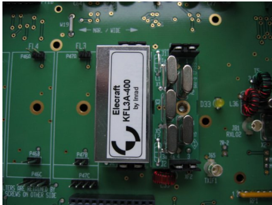
Bild: Einbau der Filter
