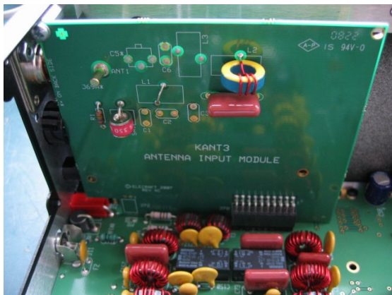
Bild: Einbau KANT3
